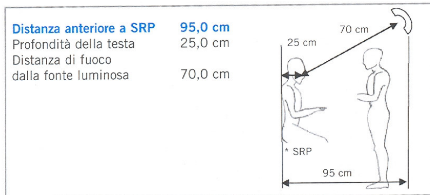
Fig. 30 Distanza anteriore a SRP (profondità della testa, distanza di fuoco dalla fonte luminosa)
